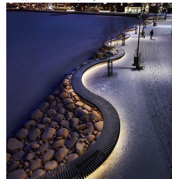
Indirekte belysning fra kanter og under benker
